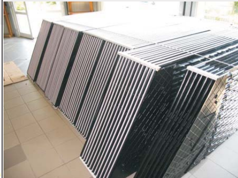
Bild 3: Fertige Module warten auf den Einbau in die Tauscherkammer
