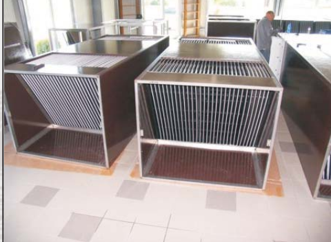
Bild 2: Fertige Tauscherkammern in der Produktion.
