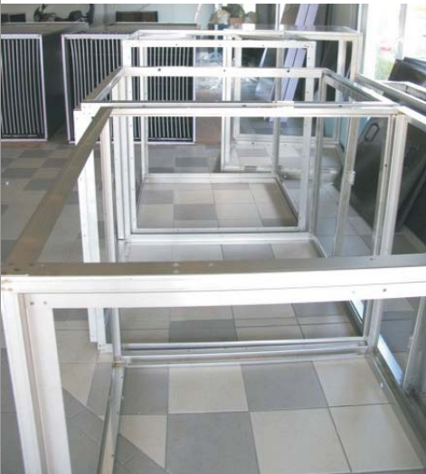
Bild 1: vorgefertigte Edelstahlrahmen in der Produktion
