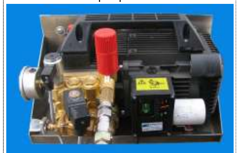
Bild 24: Hochdruckpumpe mit 70 bar
