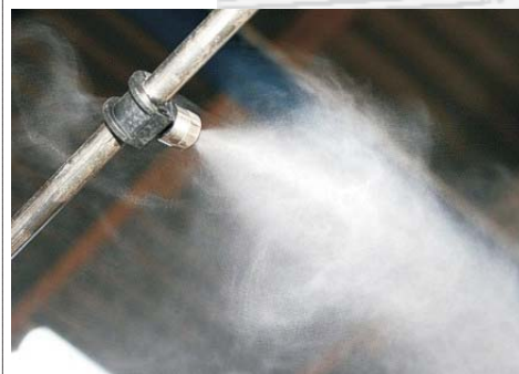
Bild 2: Typisches Sprühbild mit 70 bar Düse
