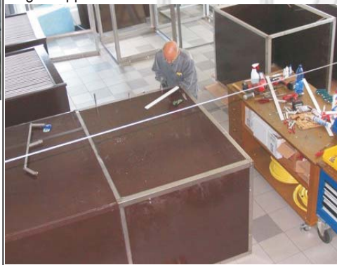
Bild 4: Handarbeit bei der Montage der Regelklappen
